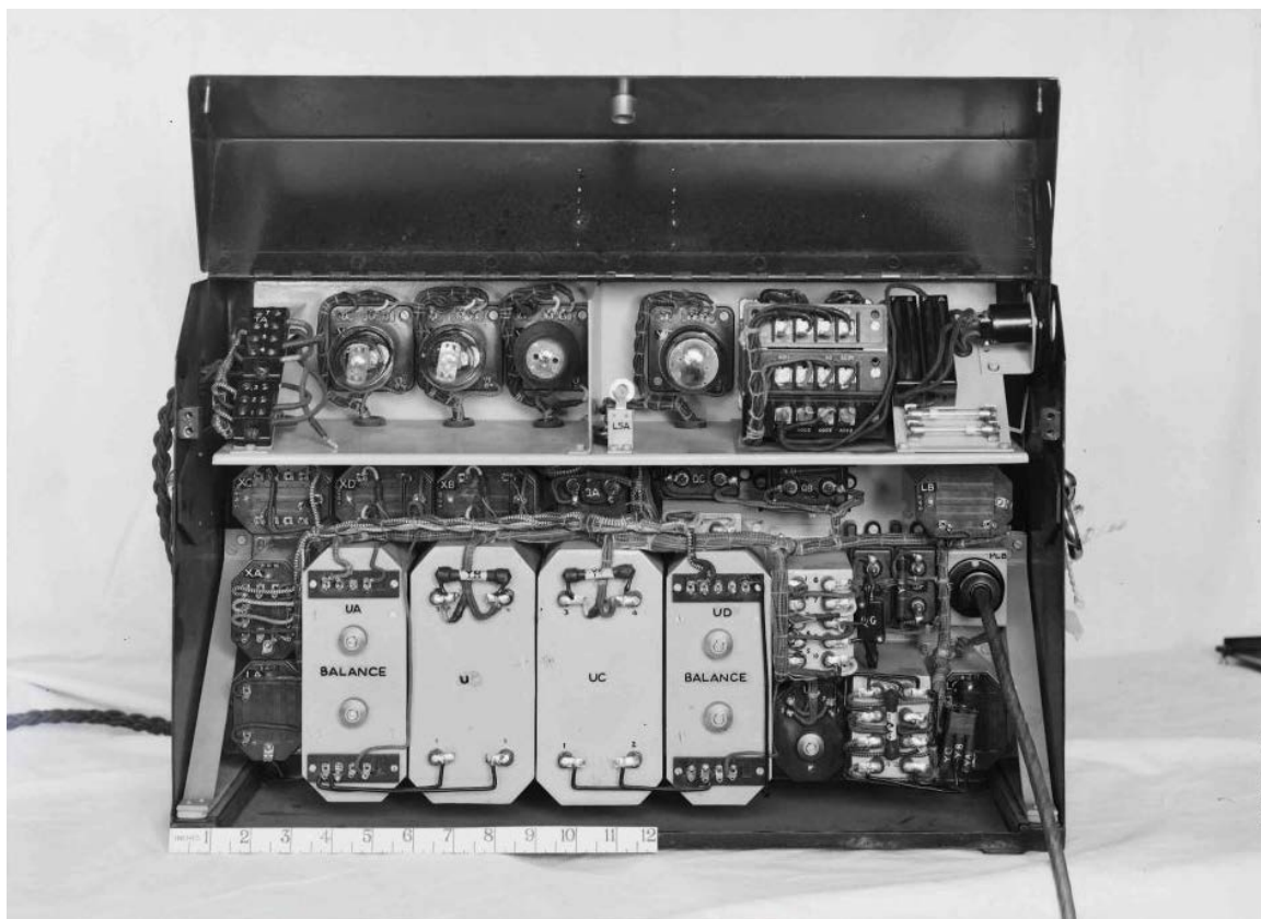
מערבל דיבור דגם 6A, ללא הכיסוי. הדגם שהיה בשימוש הבריטים מינואר 1943 הציוד מבוסס על שלוש שופרות ריק (למעלה משמאל). שופרת ריק נוספת משמשת כמיישר זרם (למעלה מימין). המכשיר ניתן להפעלה מז"ח 110 או 220 וולט.
